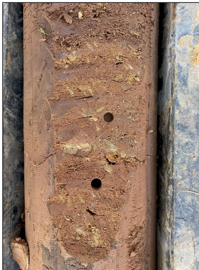
Detail písčitého jílu v sondě S2
