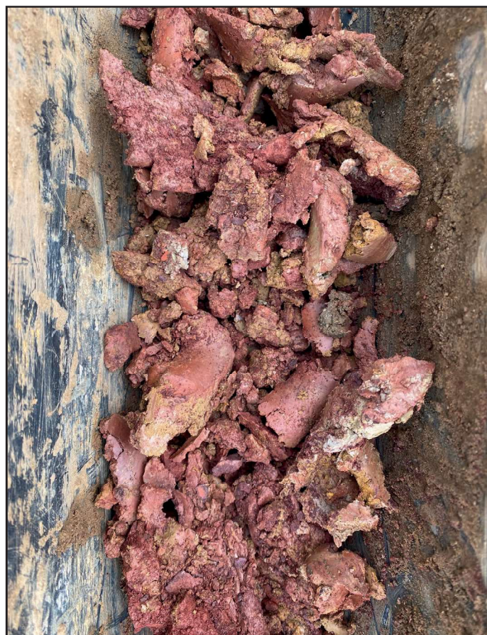
Detail eluvia v sondě S7
